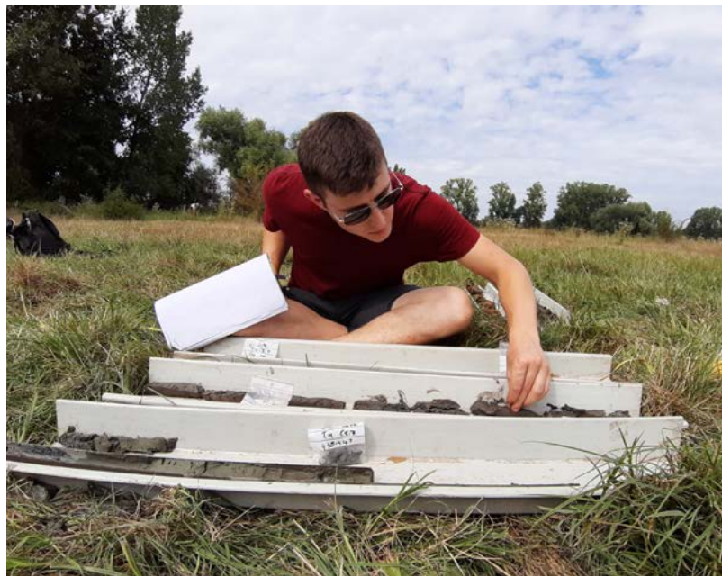
▲ Elke boring wordt in detail beschreven (kleur, textuur, gelaagdheid, insluitsels) en bemonsterd.
