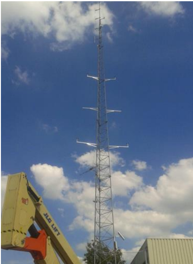
Figure 3: Meetmast met anemometers en windvanen
